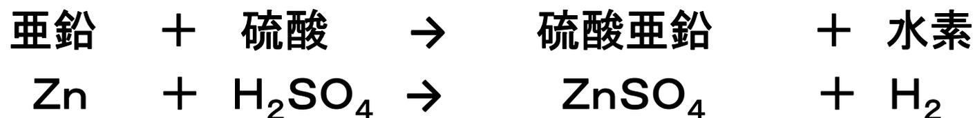
酸と金属の反応で発生する水素は、酸にふくまれていた**水素原子**が変化したものである。
